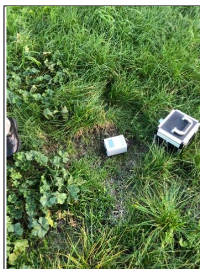
Strumentazione adottata Tromografo digitale prodotto da Micromed S.r.l.
