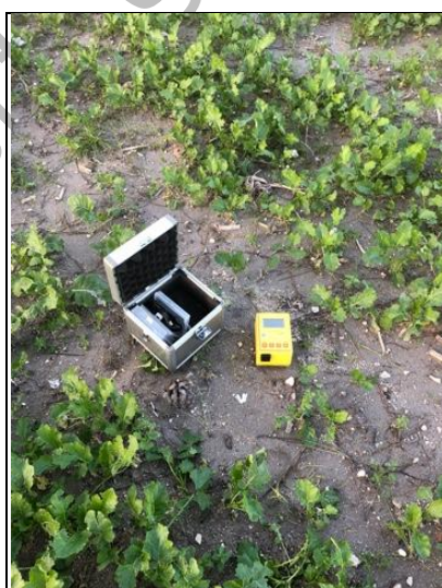
Strumentazione adottata Tromografo digitale prodotto da Micromed S.r.l.
